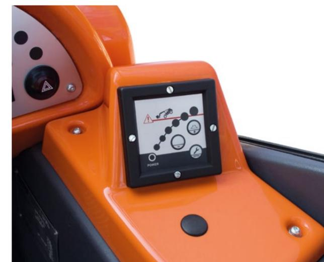
Sistema de seguridad que indica la carga de la máquina con limitador automático en caso de sobrecarga.
